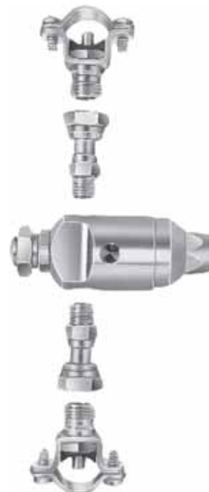
Split-Eyelet Montageschellen mit Drehgelenk 38180 zur Erleichterung der Düsenmontage
