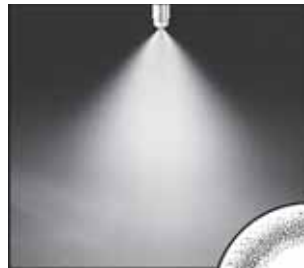
Spritzbild Feinzerstäubung Hohlkegel
