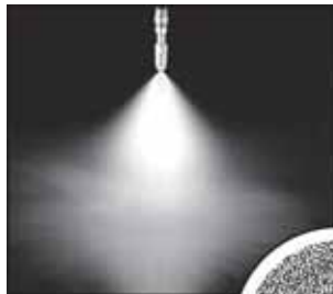
Spritzbild Feinzerstäubung Vollkegel
